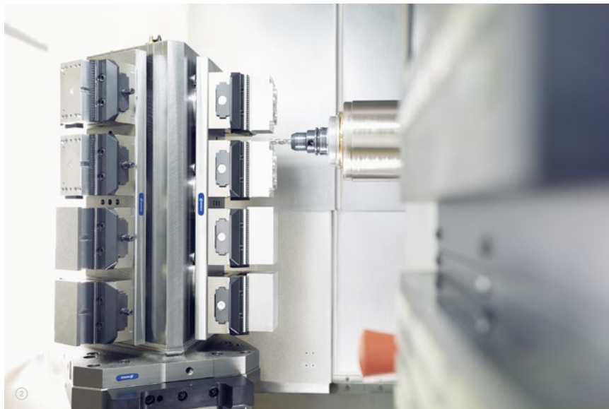
2 5 třístrannou upínací věží lze postupně obrobit až dvanáct obrobků. Základní upínače Schunk Kontec KSC zajišťují bezpečné držení. 3 Nezávisle na konstrukci mohou být individuálně konfigurovány i upínací plochy.
