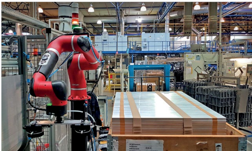
① Použití kolaborativního robota Sawyer pomohlo snížit náklady na automatizaci pracoviště zhruba o polovinu.
