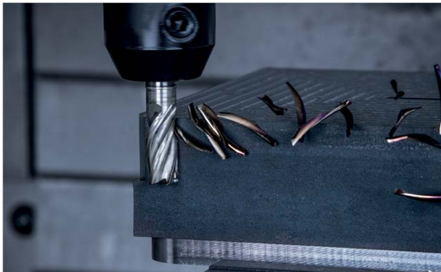
Nová generace fréz SilverLine dosahuje vyšší životnosti až o 40 % při zvýšení řezné rychlosti o 20 až 30 procent.
