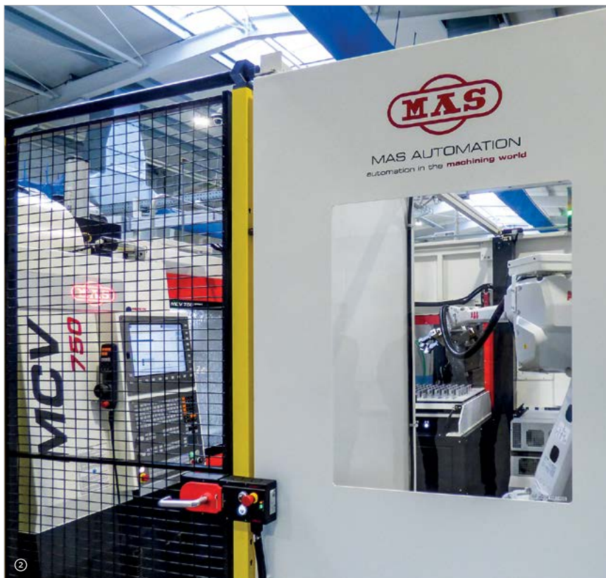
2 Základem robotizované buňky od MAS Automation jsou dva stroje MCV 750 a robot od ABB.
