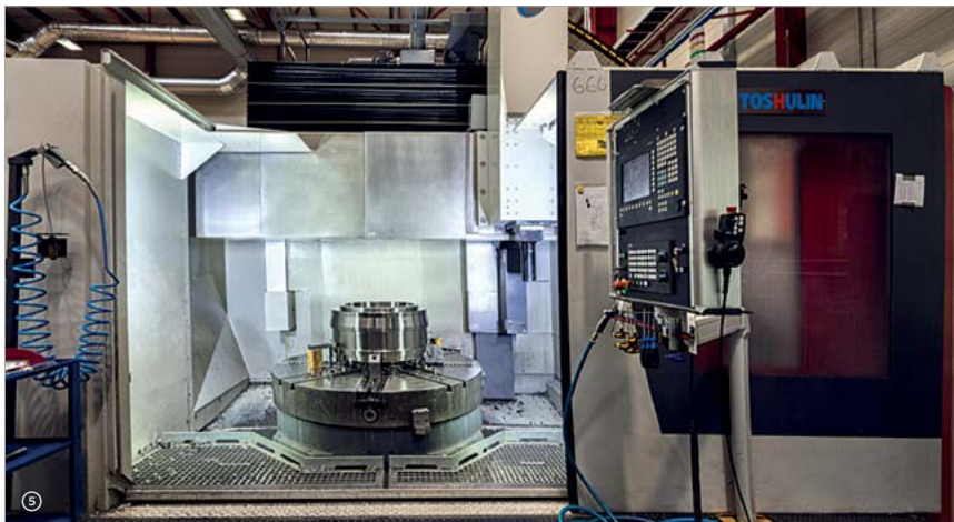
5 V PCC převažují obráběcí stroje karuselového typu od českého výrobce TOSHULIN.
